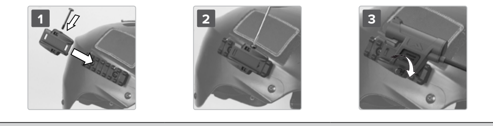
Figura 9 – Montaje sobre riel (ABR)
