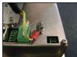
7) Connect MEC sensor earth to earth stud
