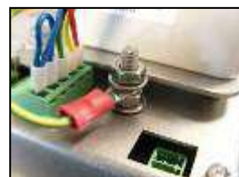
11) Connect MEC sensor earth to earth stud
