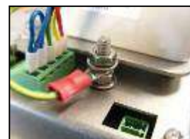
11) Connect MEC sensor earth to earth stud
