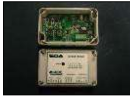
1) Remove lid from output module
