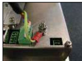
7) Connect MEC sensor earth to earth stud
