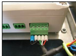
6) Connect output module cable
