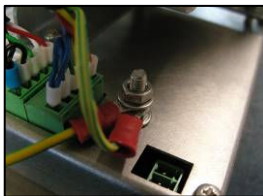
7) Connect output module earth to earth
