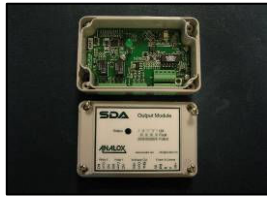
1) Remove lid from output module
