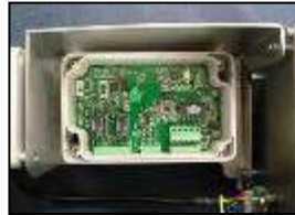
4) Tighten the M4 Pozi-Pan screws
