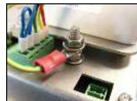
11) Connect MEC sensor earth to earth stud
