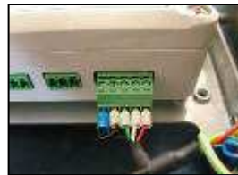
6) Connect output module cable
