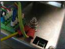
7) Connect output module earth to earth
