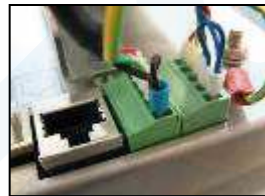
6) Connect output module cable
