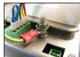
11) Connect MEC sensor earth to earth stud
