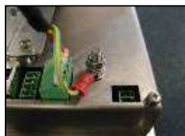
7) Connect MEC sensor earth to earth stud
