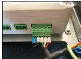
6) Connect output module cable
