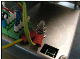
7) Connect output module earth to earth
