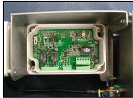
4) Tighten the M4 Pozi Pan screws
