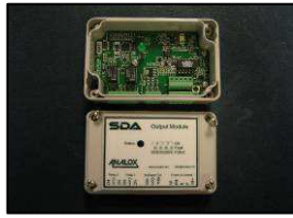
1) Remove lid from output module
