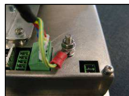
7) Connect MEC sensor earth to earth stud
